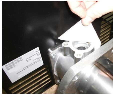
2) повернуть Горелка и Снять заглушку;
