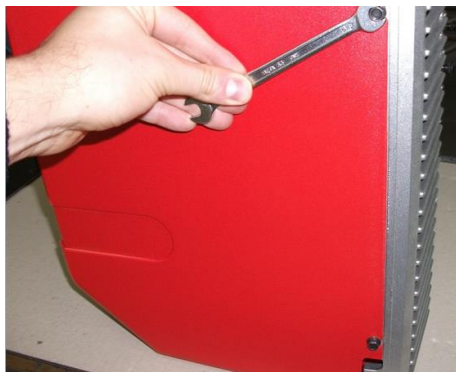
1) Снять кожух, ослабив 4 винта;
