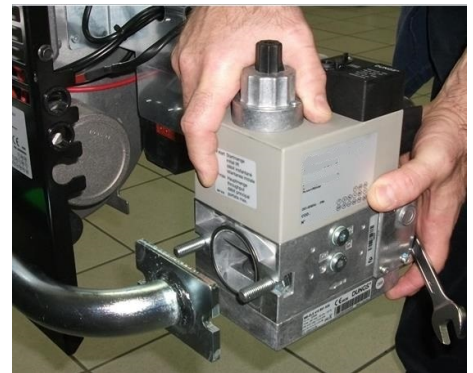
9) установить электроклапан на Труба ГАЗОВОЙ рампы;
